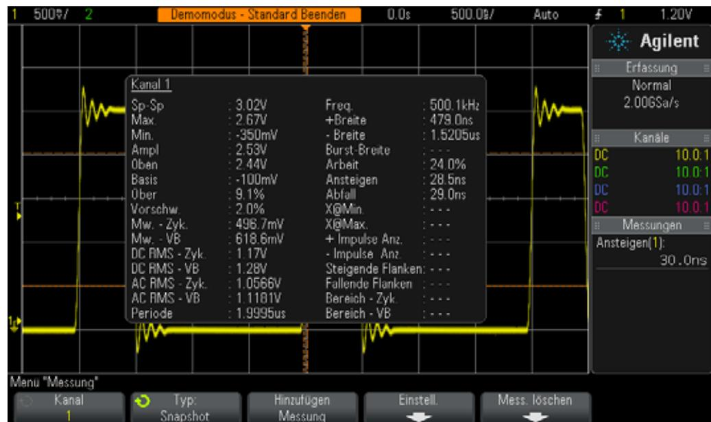
**Abbildung 35** Durchführen einer umfassenden, automatischen Parametermessreihe mit der Funktion „Snapshot All“
