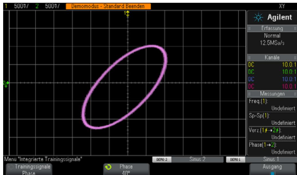
**Abbildung 40** Lissajous-Figur, die durch den XY-Oszilloskopmodus von zwei Sinuswellen derselben Frequenz erzeugt wurde und eine Phasenverschiebung von 48 Grad zwischen den beiden Sinuswellen aufweist
