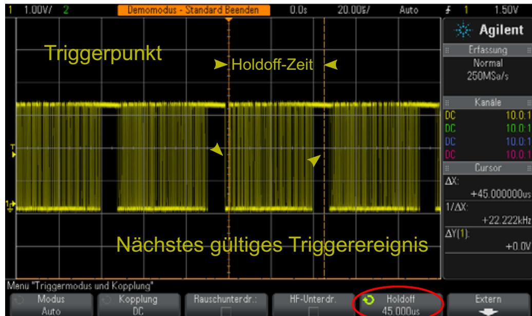
**Abbildung 27** Verwenden der Trigger-Holdoff-Funktion des Oszilloskops für die Synchronisierung von Impuls-Bursts
