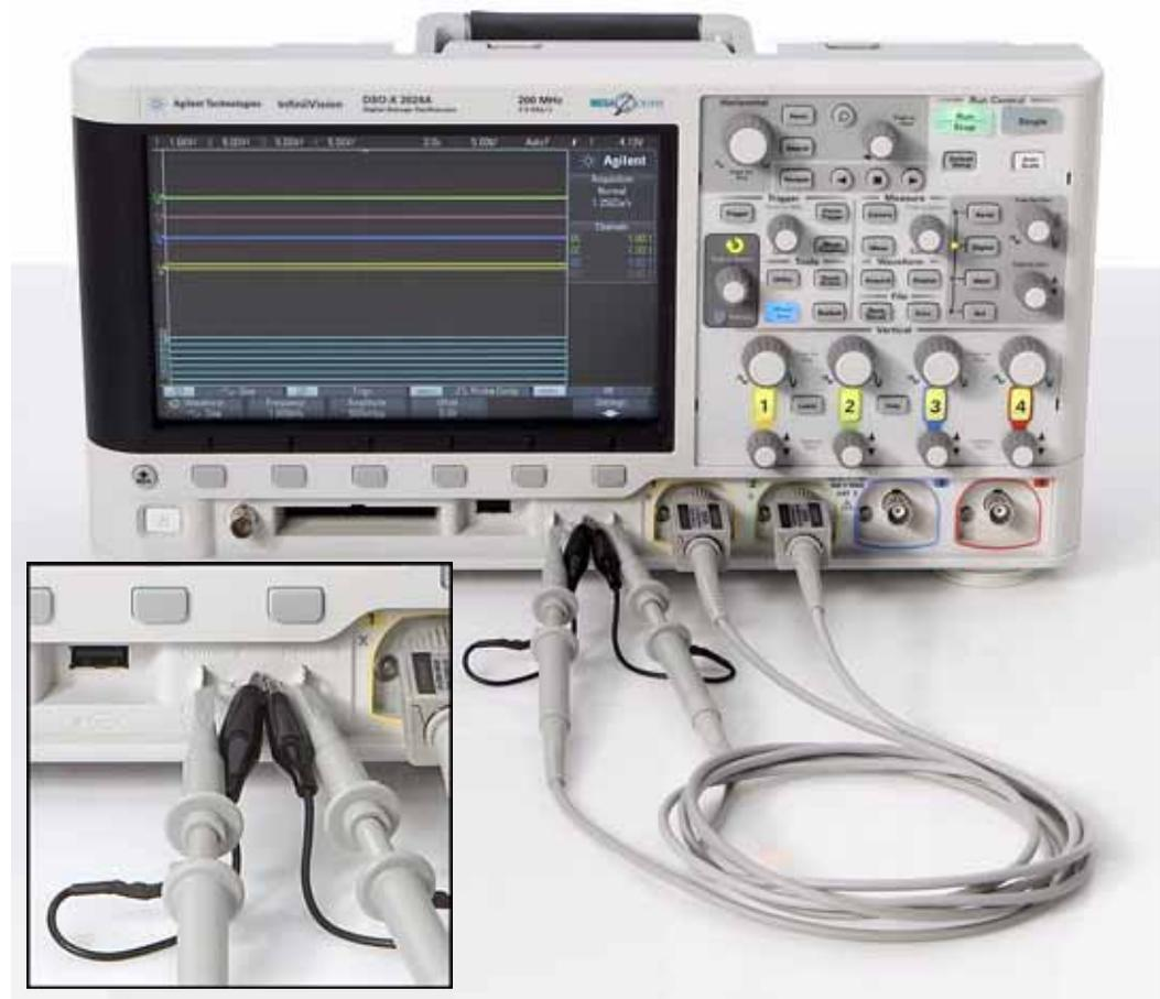
**Abbildung 8** Verbindung der Tastköpfe mit den Kanal-1- und Kanal-2-Eingängen und den Ausgangsanschlüssen des Trainingssignals
