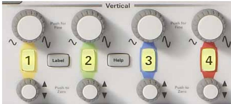
**Abbildung 5** Vertikal-Steuererelemente (Y-Achse) des Oszilloskops
