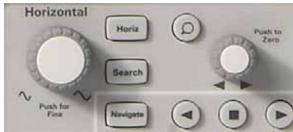
**Abbildung 4** Horizontal-Steuerelemente (X-Achse) des Oszilloskops
