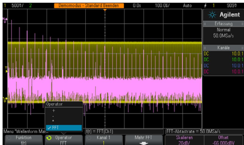
**Abbildung 43** Durchführen einer mathematischen FFT-Funktion bei einem sich wiederholenden digitalen Taktsignal
